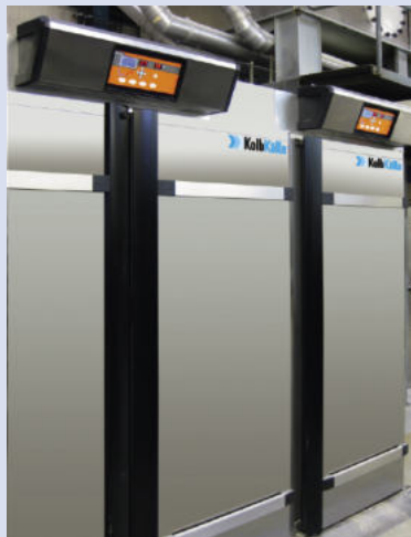
Cellule de surgélation rapide et Cellules de fermentation contrôlée de Panem.
