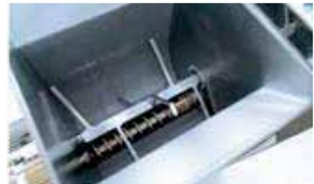
Verschraubter Presskanal aus Edelstahl. Abschneider seitlich wegklappbar.
