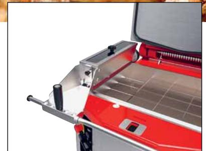
*Easyflour ermöglicht das Bemehlen der Teigmulde in einer einzigen ergonomischen Bewegung.*
