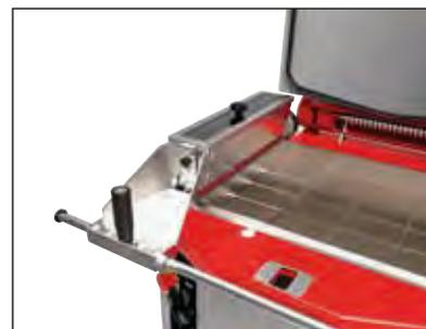
*Le Easyflour permet de fleurir la cuve d'un simple mouvement fluide et ergonomique*
